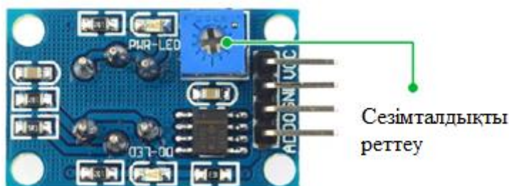
2.9 - сурет – MQ-2 газ датчигі модулінің сезімталдығын реттеуге арналған потенциометр
