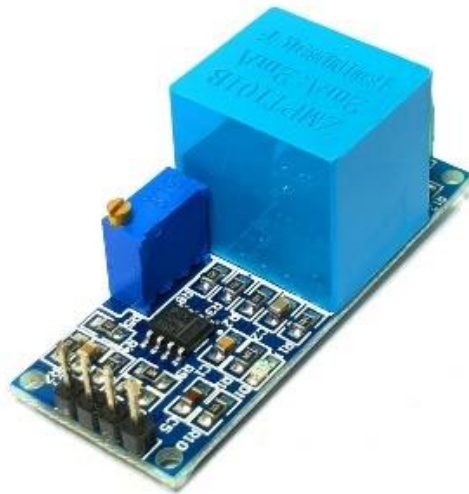
2.2 - сурет – ZMPT101B датчигінің сыртқы көрінісі
